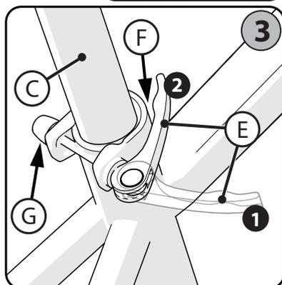
**AVERTISSEMENT :** Il faut forcer fermement pour déplacer la vis à papillon en position « **FERMÉE** » ② et la maintenir bien fixe. Cela permet d'éviter que la selle ne bouge pendant son utilisation normale.
