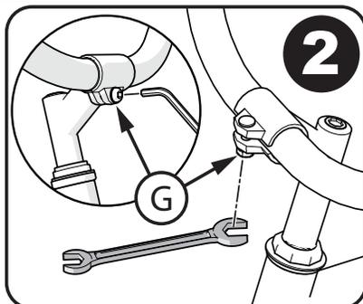
**⚠ AVERTISSEMENT :** Ne pas trop serrer le boulon de la potence. Si le boulon de la potence est trop serré, cela peut endommager le système de direction et provoquer une perte de contrôle.
