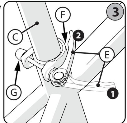
**⚠️ ADVERTENCIA:** Se debe aplicar bastante fuerza para mover la palanca de liberación rápida firmemente hasta la posición cerrada ("CLOSE") **(2)**. Esto asegura que el asiento no se mueva durante el funcionamiento normal.
